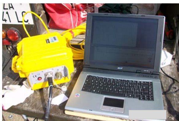
Figura 4.2.1.1: Ripresa fotografica della strumentazione utilizzata per l'acquisizione dei dati sismici: da sinistra sismografo GEODE, PC data logger, geofoni collegati al cavo geofonico (foto di archivio).
