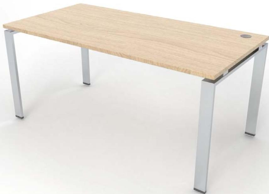
Postazioni di lavoro realizzate con **struttura portante** completamente in acciaio proveniente **per almeno il 90% da riciclo di cascame** composta da 2 fiancate U capovolta realizzate con tubolare a sezione rettangolare mm 60x25 spessore mm 1,5 e 2 travi aventi funzione di supporto del piano e passacavi in lamiera stampata spessore mm 2.
