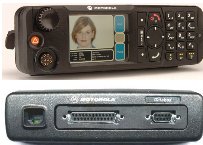
Figura 5: apparato MTM800 con unità di comando e ricetrasmittitore separati
